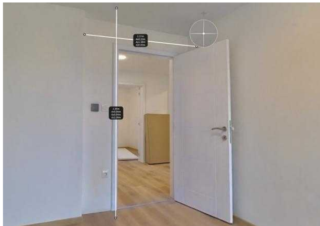
Slika 4.5 Primjer mjerenja udaljenosti unutar 3DGS prikaza interijera
