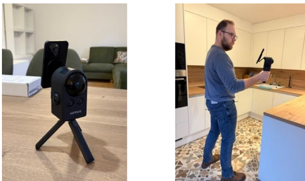
Slika 4.1 Ručni mobilni SLAM sustav XGRIDS PortalCam tijekom snimanja interijera
